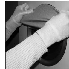
Introduisez le cache à partir du haut de la couronne en veillant à ce que l'élastique passe entre le profil en aluminium et la caisse.
