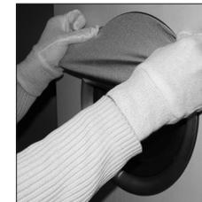
Nehmen Sie den Stoff und beginnen diesen von oben über den Aluminiumring zu ziehen. Achten Sie darauf, dass der Stoff auch zwischen Ring und Gehäuse ist.
