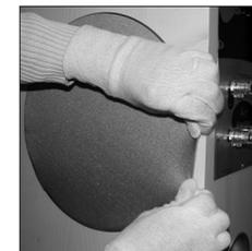
Tirez sur le cache pour répartir l'élastique de façon homogène sur le pourtour de la couronne.
