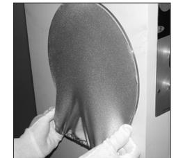
Ziehen Sie den Stoff fest nach unten, dass dieser glatt ist und lang genug für die Unterseite des Ringes.
